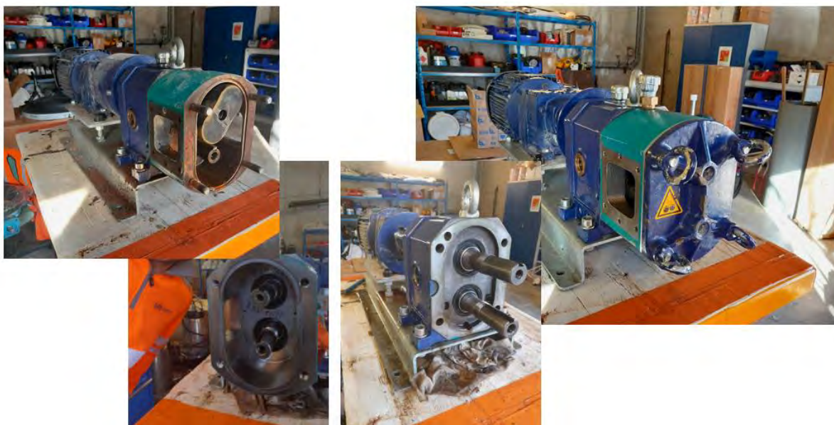
2023-01- Cette semaine, à l'atelier #UGD rénovation bien nécessaire d'une pompe à lobes de la marque Börger.
