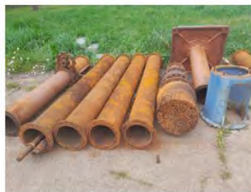
2023-03 Démontage d'une pompe à ligne d'ar bre sur l'usine de Florensac.
